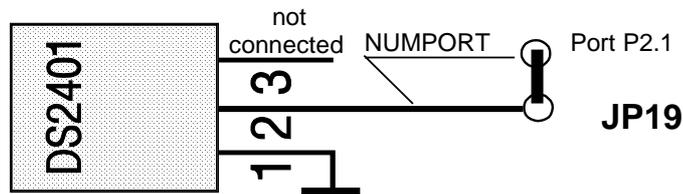
Figure 28: Connecting the DS2401 Silicon Serial Number
