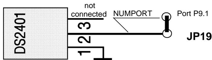
Figure 33: Connecting the DS2401 Silicon Serial Number
